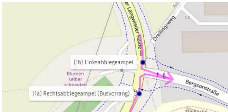
Die beiden Abbiegeampeln 1a und 1b machen die Überquerung der Bergsonstraße an der Ampel für Fußgänger und Radfahrer sicherer und erlauben den Durchgangsverkehr in die Obermenzinger Bergsonstraße hinein zu begrenzen. Auf Grund der Berufsschule und der Flüchtlingsunterkünfte sind hier speziell auch heute bereits viele Kinder unterwegs. Mit dem Neubaugebiet am Dreilingsweg und der geplanten Schule wird die Zahl der Kinder noch deutlich zunehmen.
